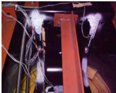
加速度センサ・歪ゲージを被試験体に装着。カラーチェックで亀裂を観察
