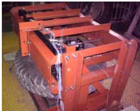
スペアタイヤキャリアと取付ブラケットの振動試験の様子
